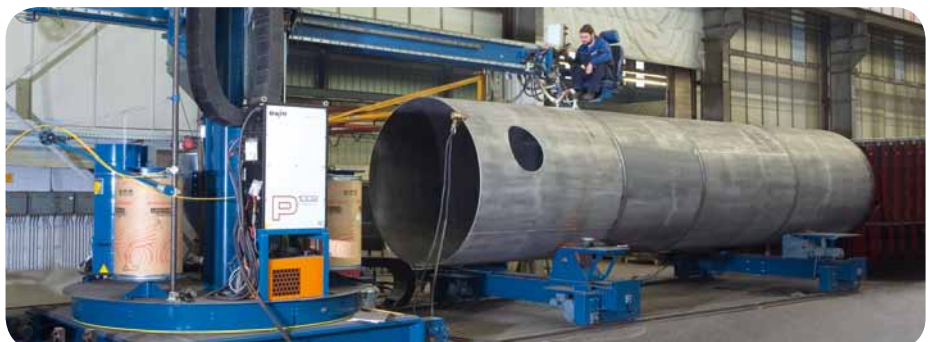
UP-Schweißen eines Druckbehälters nach DIN EN 13445 / Submerged-arc-welding (SAW) of a pressure vessel according to DIN EN 13445
